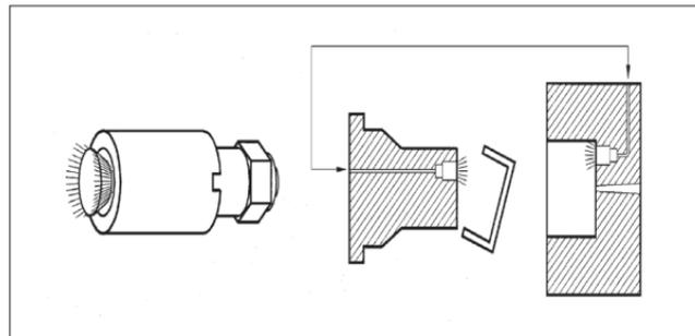
Vengono impiegate per compensare il vuoto durante la fase di estrazione in cavità profonde o per immettere aria. Costruite interamente in acciaio 1.2083, temprate e rettificate, con dado autobloccante.
