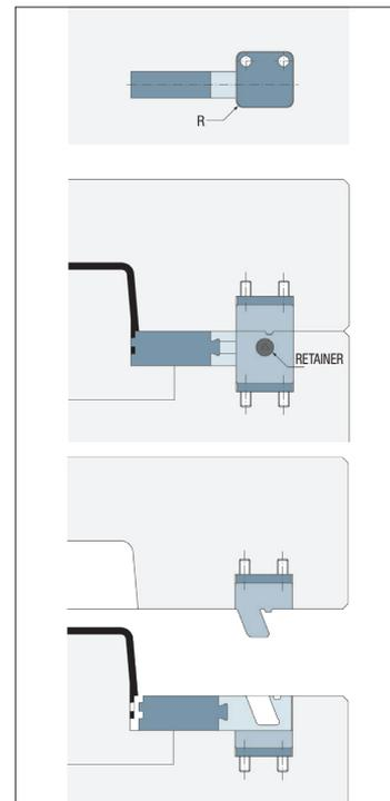
Ideale per liberare dettagli esterni Gruppo compatto con corsa fino a 5mm. Il Carrello è composto da due parti, il che facilita la sua lavorazione. Tutte le lavorazioni necessarie sono a 90° rispetto alla linea di divisione dello stampo. Facilità di cambio degli inserti, grazie al suo particolare metodo di fissaggio. Incorpora la guida inclinata e un ritenitore del carrello.
