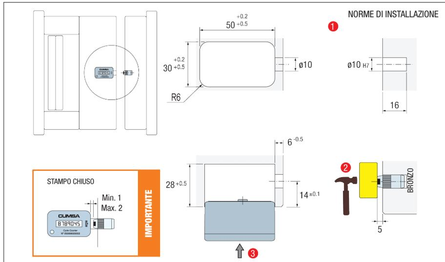
Permette di controllare la produzione totale dello stampo. Consente il controllo della produzione dello stampo quando si subappalta. Permette di stabilire i piani di manutenzione.
