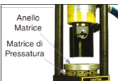
**Matrici di pressatura** - Usate in una unità portatile di pressatura per ottenere tubi flessibili assemblati permanenti. Per informazioni sulla costruzione di tubi flessibili assemblati, consultare il Bulletin B00120C.
